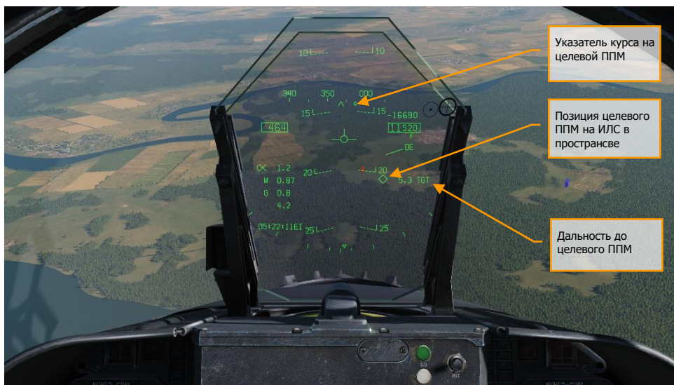
Рисунок 73. Индикация целевого ППМ на ИЛС
