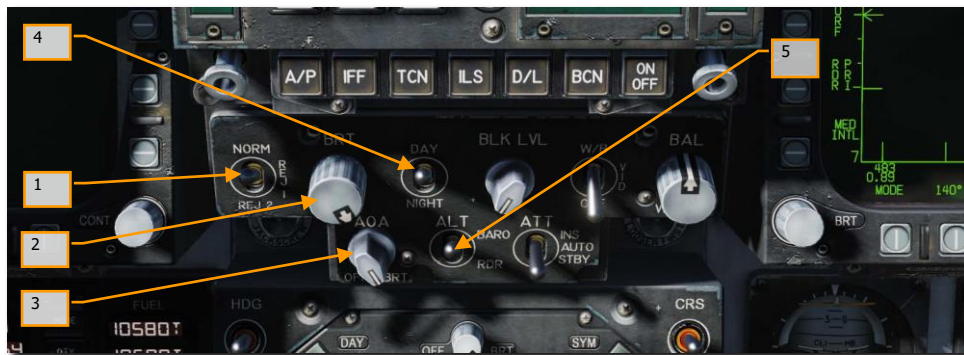
Рисунок 13. Панель управления ИЛС
