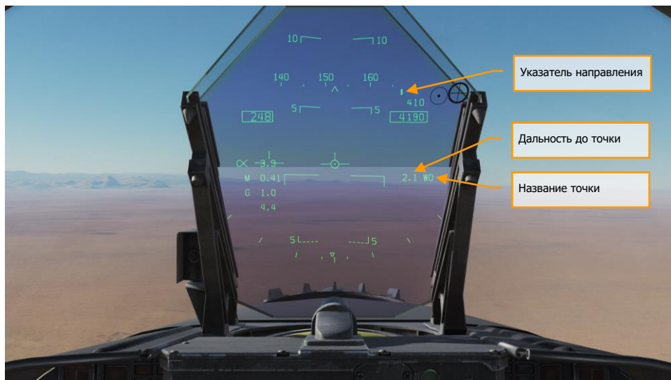
Рисунок 47. Навигационная информация на ИЛС
