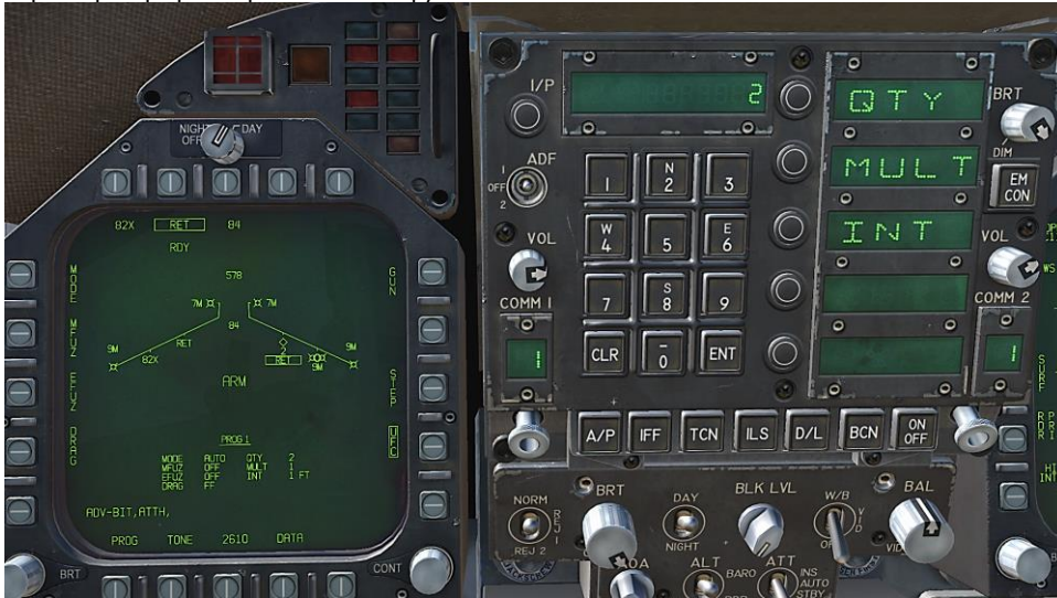
При нажатии опциональных кнопок на UFC, можно выполнить изменение значения параметра профиля вооружения. Выбранный параметр отображается символом ":" :
