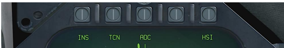
Рисунок 44. Выбор источника навигационных данных
