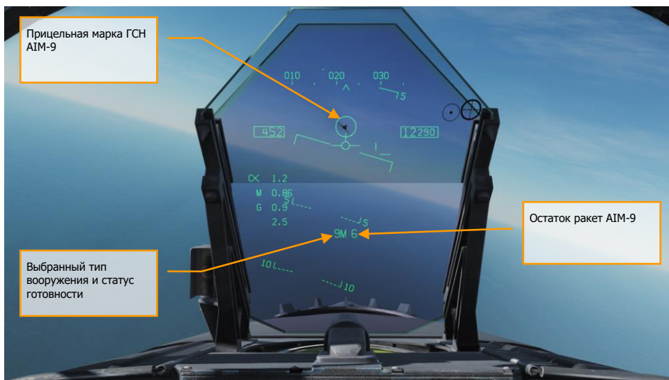
Рисунок 97. AIM-9 HUD, Seeker Boresight
