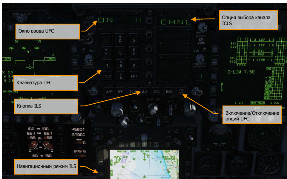
Рисунок 63. Настройка ICLS
