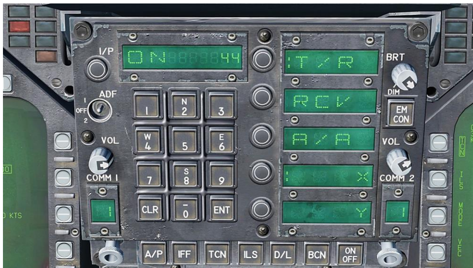
Рисунок 54. Опции TACAN на UFC
