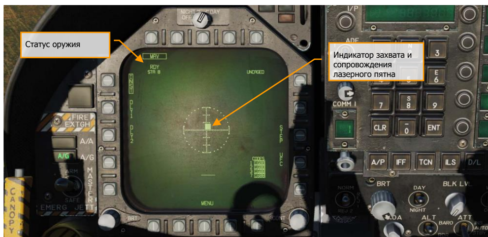
Рисунок 82. Индикация захвата цели на странице AGM-65E
